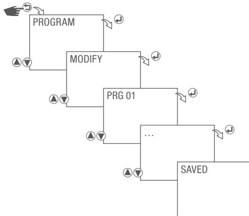
Abb. 31: Astro-Schaltprogramm bearbeiten
