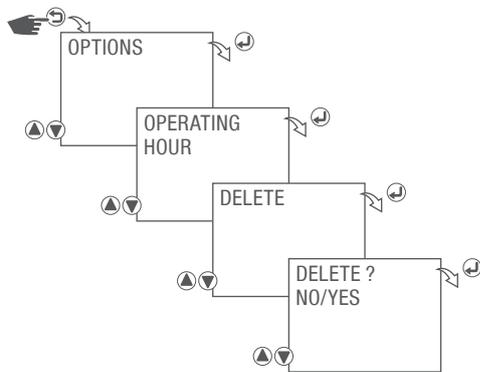
Abb. 21: Betriebsstundenzähler löschen
