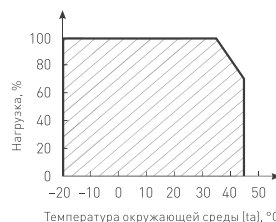
Рисунок 4. Максимальная допустимая нагрузка, % от мощности источника
